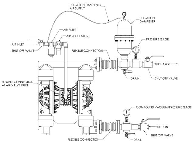
PUMP MUFFLER IS ON THE BACK SIDE OF THE PUMP. IT CAN BE REMOVED AND EXHAUST CAN BE PIPED TO DESIRED LOCATION.
